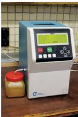
**Массовая доля серы в бензине быстро определяется с помощью рентгенофлуоресцентного энергодисперсионного спектрометра**
