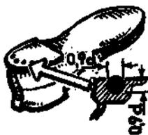
Увеличить срок носки сапог помогут стальные шарики, вдавленные в просверленные в каблуках отверстия, глубиной и диаметром чуть меньше диаметра шарика. Таким способом, кстати, шилуются автомобильные покрышки. Шарики не уступают подковкам, а стук при ходьбе издают гораздо меньший.
