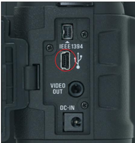
**Рис. 2.17.** Для подключения камеры к компьютеру используется USB-разъем
