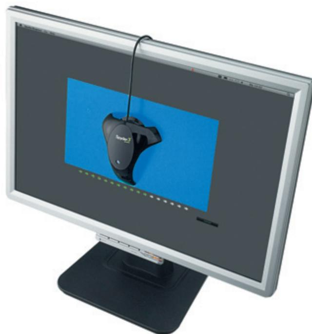
**Рис. 1.8.** Для калибровки монитора используется колориметр
