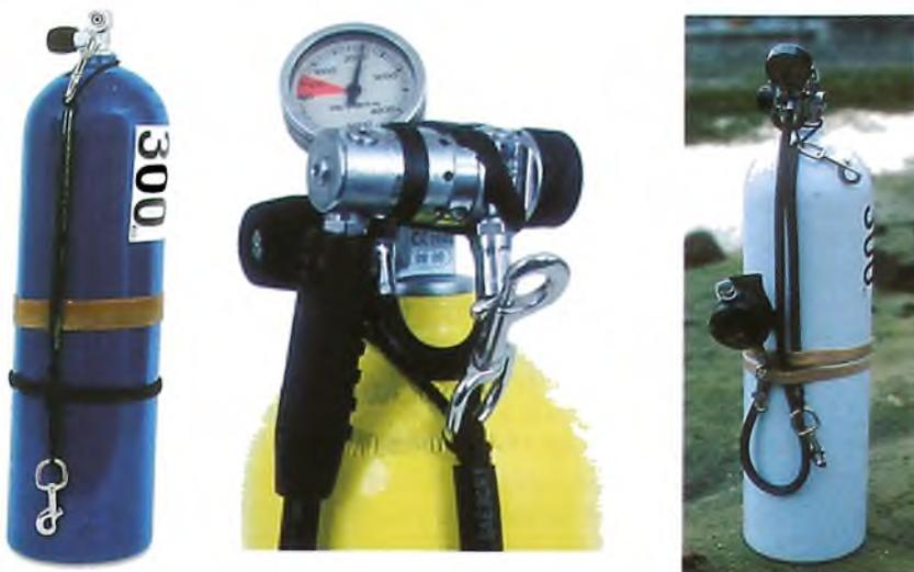
*Слева: стальной затягивающийся хомут крепится вокруг баллона и закрепляет подвеску из 6-мм веревки. Такой вариант не имеет крепления металл-на-металл.*
