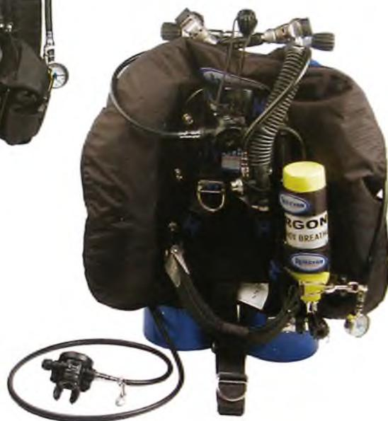
*DIR-прокладка шлангов для спарки. Шланг основного регулятора и шланг поддува компенсатора должны всегда идти от правой стойки. Шланг запасного регулятора, манометр и шланг сухого костюма идут от левой стойки.*
